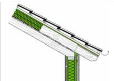
Traufe mit Schnitt durch den Stichsparren
