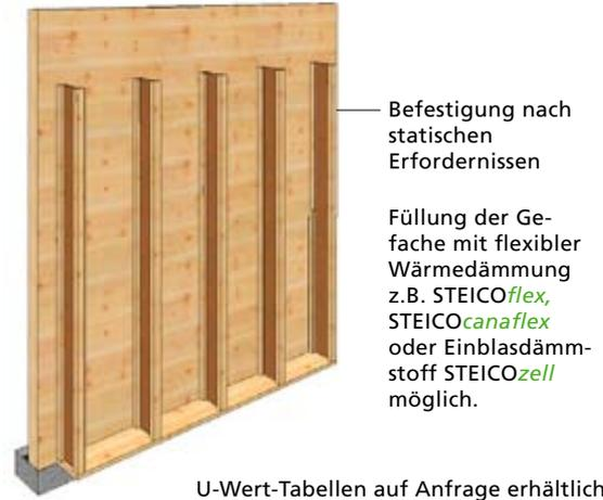
Die Befestigung der STEICOWall Stegträger erfolgt durch den hinteren Gurt mittels zugelassenen, selbstbohrenden Holzschrauben 5,0x110, welche im Abstand von 50 cm wechselseitig, einmal links, einmal rechts vom Steg eingeschraubt werden. Der Randabstand beträgt  $3 \times D = 15 \text{ mm}$ . Es gelten die auf Seite 35 genannten Annahmen/Hinweise.
