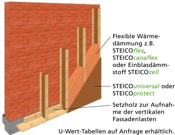
**W10 Halbierte STEICOwall Träger über Kantholz auf Mauerwerk**
