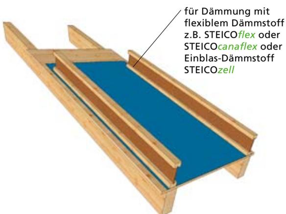
für Dämmung mit flexiblem Dämmstoff z.B. STEICOflex oder STEICOcanaflex oder Einblas-Dämmstoff STEICOzell
