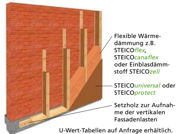
**W11 Befestigung: Mittels Metallwinkel und CSA-Schrauben**
