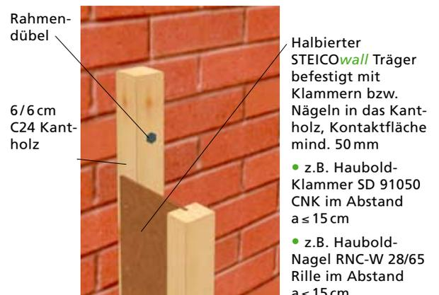
**Befestigung des Winkelverbinders bzw. des Kantholzes ins Mauerwerk mittels Rahmendübel.**
