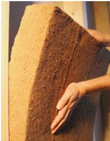
Dank der Flexibilität des Dämmstoffes können kleinere Unebenheiten mühelos ausgeglichen werden.
